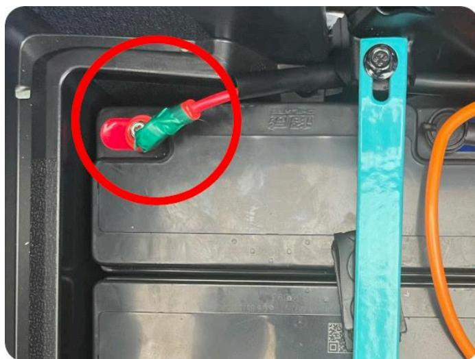
Le deuxième fil éventuellement débranché reliera l'unité de commande à la borne ouverte du disjoncteur. Retirez le ruban adhésif et insérez-le dans la borne ouverte sur le côté du disjoncteur, puis serrez la vis pour le fixer.
