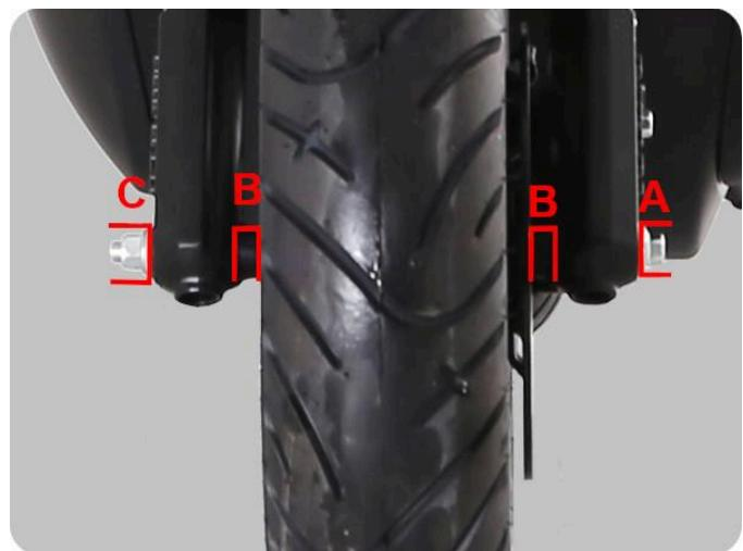
Terminez l'assemblage de la roue avant en fixant l'étrier de frein. Insérez l'étrier sur le disque de frein et alignez-le avec les trous de fixation de la fourche avant. Vissez l'étrier avec les boulons fournis. Testez le fonctionnement du levier de frein et serrez/desserrez si nécessaire.
