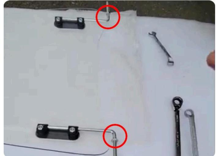
Glissez ensuite l'un des supports filetés dans le logement des clips de fixation métalliques que vous venez d'installer. Pliez délicatement le pare-brise pour permettre à l'autre support de s'insérer dans le clip de fixation du côté opposé.
