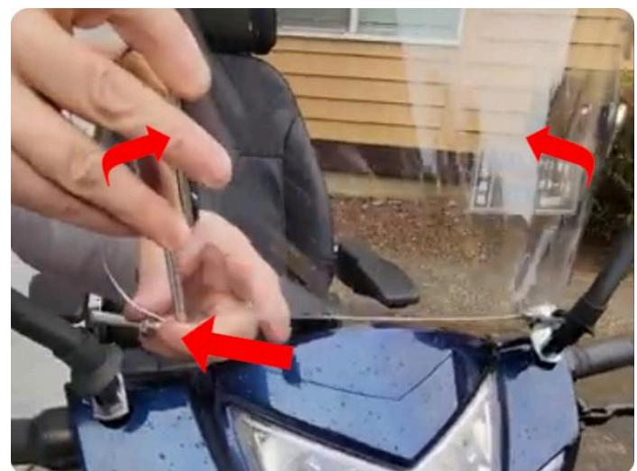
Ajoutez les deux écrous restants aux extrémités de la partie filetée du support. À l'aide de deux clés, serrez les écrous vers le clip de fixation pour les fixer. Répétez l'opération de l'autre côté, puis serrez les deux rétroviseurs.
